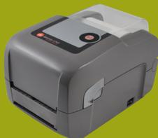
Das Advanced-Modell ist für Anwendungen gedacht, die auf Netzwerkanbindung, höhere Druckgeschwindigkeiten oder spezielle Druckmaterialkompatibilität angewiesen sind. Es enthält alle Funktionen und Optionen des Grundmodells Basic und bietet darüber hinaus parallele und Ethernet-Kommunikationsanschlüsse, einen positionierbaren Indextsensor und druckt bis zu 5 Zoll pro Sekunde.
